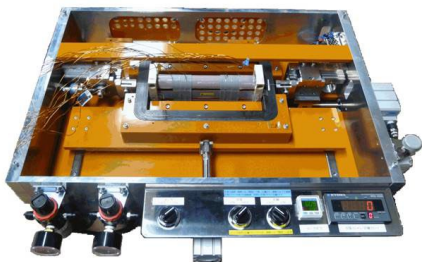
応力負荷型単板磁気試験器（電磁鋼板評価） 【高精度測定】【特許 5709695 号】
