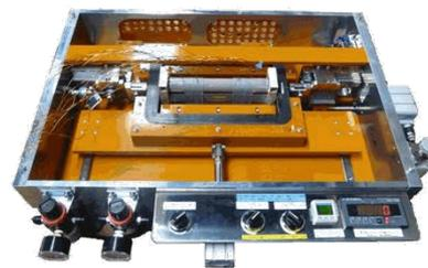
応力負荷型単板磁気試験器
