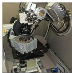
X線残留応力測定装置
