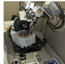
X線残留応力測定装置
