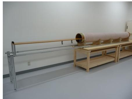
独PTB校正標準コイルによるHコイル校正
