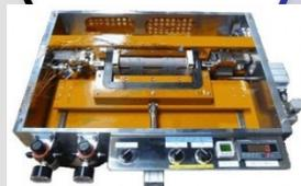
応力負荷型単板磁気試験装置
