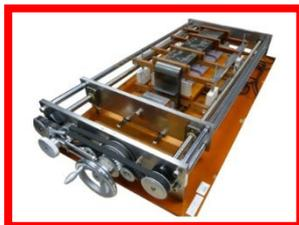
応力負荷型単板磁気試験器
