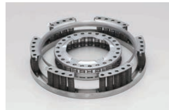
■クラッチリターン springs 組立 自動変速機内で使用され、コイルばねをプレート2枚で固定する構造により、ねじれ剛性向上と自動組み立てを可能にしました。
