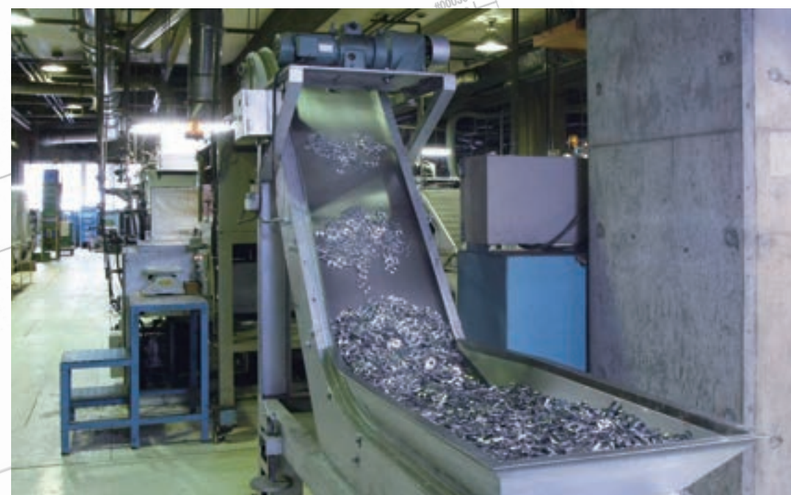
計量自動投入機
