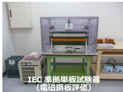
応力負荷型単板磁気試験器（電磁鋼板評価） 【高精度測定】【特許 5709695 号】
