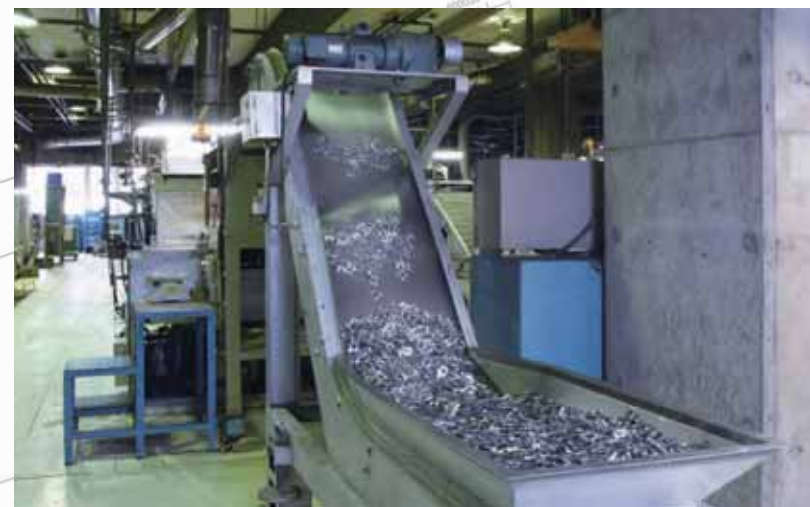
計量自動投入機
