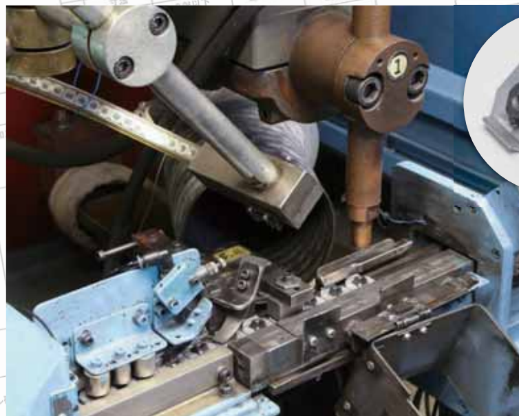
スポット溶接ライン
