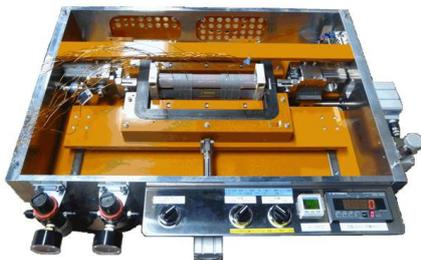
応力負荷型単板磁気試験器(電磁鋼板評価)
