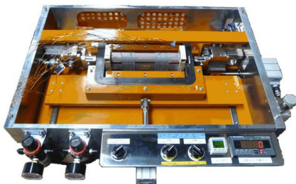
応力負荷型単板磁気試験器（電磁鋼板評価） 【高精度測定】【特許 5709695 号】
