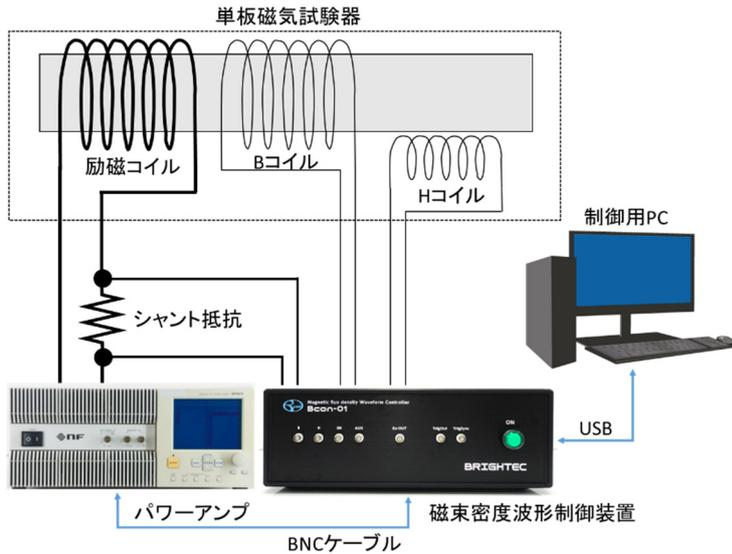
磁束密度波形制御装置に単板試験器を接続した例です。
