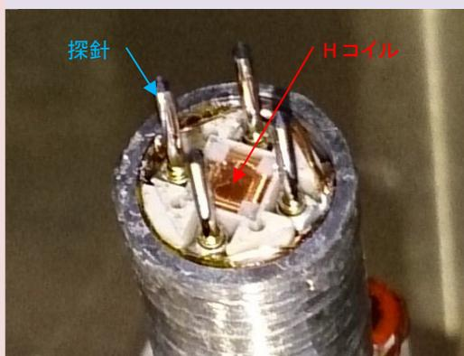
モータの複雑な形状で狭い領域でも測定可能です。極細線の加工技術を駆使し、極小局所2次元磁気センサを開発しました。
