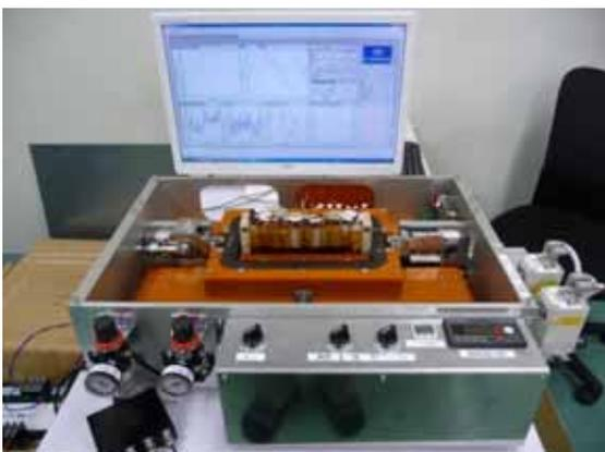
応力負荷型単板磁気試験器
